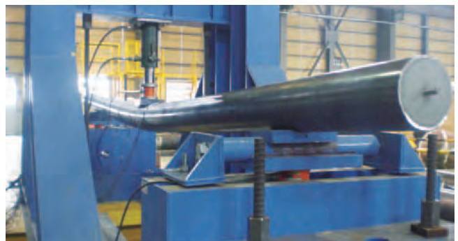
静的荷重載荷実験のようす 支柱部材の耐力は、実物の支柱供試体を用いた載荷実験によって確認されています。
